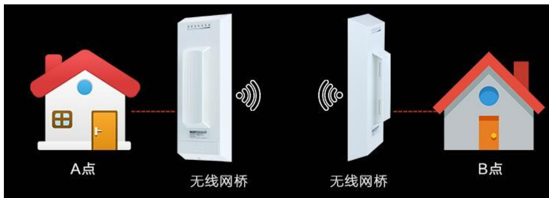
图 4-1: 室外点对点桥接
