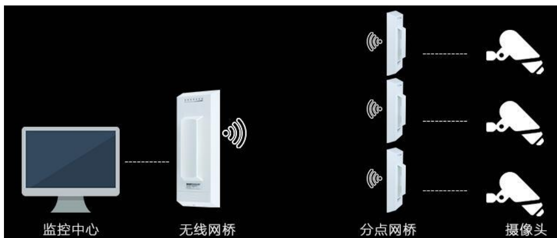
图 4-2：室外点对多点桥接
